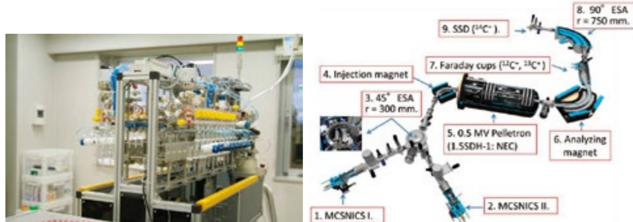
図1. 山形大学総合研究所に設置された自動グラファイト処理システム (左図) と高感度加速器質量分析装置 (右図)
