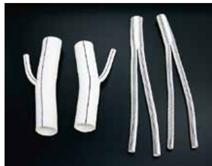
高分子材料を素材として作られた人工血管。内径数センチにも及ぶ太い血管は心臓周辺に使用されるもの。需要の高い内径4ミリ以下の人工血管は今のところ実現に至っていない。
