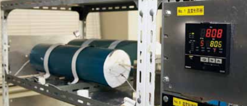
自作電気炉。左がラックに取りつけられている電気炉本体で、右が温度制御器。試料を1,000°Cまでの高温にすることが可能。
