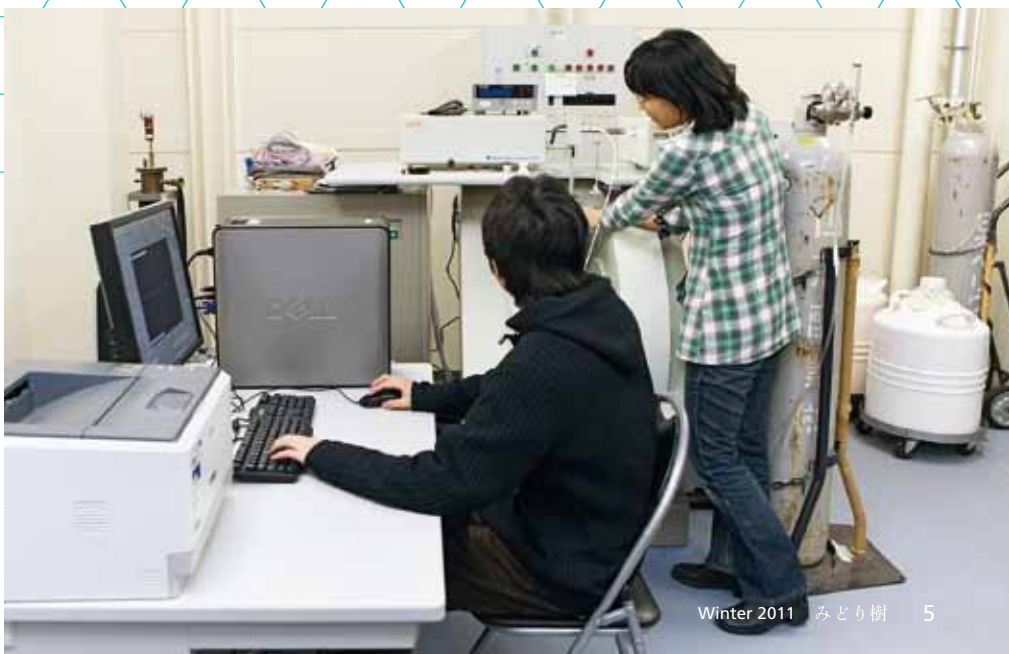
電子スピン共鳴(ESR)装置で実験している学生。ESR法は、物質中における電子のスピン状態を調べる方法である。現在、この装置にスピン状態の時間変化を高速で調べられる時間分解磁気共鳴装置の設置を行っており、それを用いたトポロジカル絶縁体などの研究を計画している。
