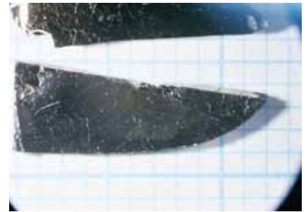
育成した結晶の実体顕微鏡写真。石英管に原料を真空封入し、900℃程度の高温で \text{Bi}_2\text{Te}_3 を合成し、ゆっくり冷やすと \text{Bi}_2\text{Te}_3 のインゴット(塊)が出来る。それから写真のような単結晶を切り出す。
