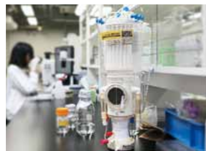
心臓手術の際に一時的に心臓と肺の代役をする人工心肺装置。血液の凝固を防ぐ、より優れた生体親和性材料の開発によるさらなる改良が求められている。
