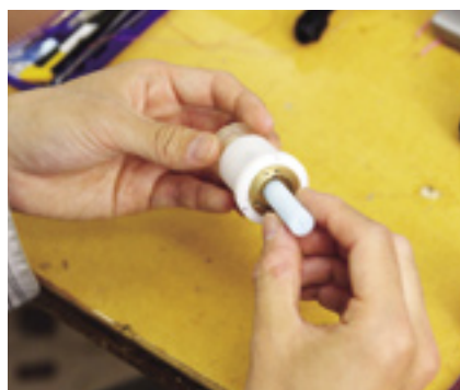
現段階では、研究室の学生たちによって一台一台手作りされている点接触式固体熱物性テスター。
