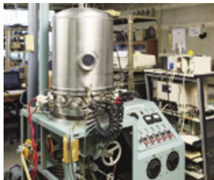
より適用範囲の広い熱物性測定装置。研究室にある大掛かりな装置のため、試験片を持ち込んで測定や解析が行われる。
