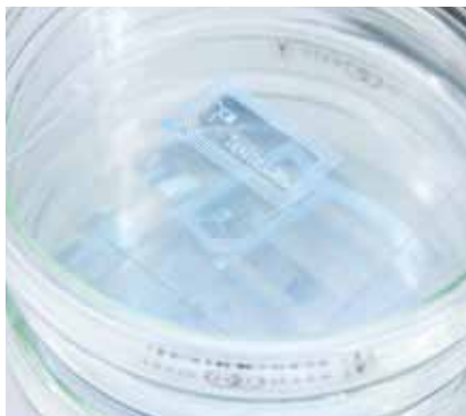
シャーレの中にかすかに見えているのが印刷法でのトランジスタの試作品。小さく「Tokito Lab」と書かれている。
