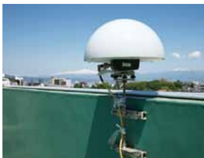
理学部の屋上に設置されている GPS 観測装置。山形、上山、天童、尾花沢など県内十数カ所に設けられている観測点との距離を日々データ化し、年間でどれくらいの地殻変動が見られるかの調査・分析を行っている。
