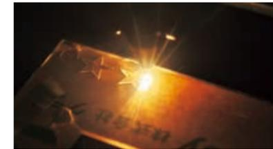
レーザーカッターは、加工素材にレーザー光を照射し、蒸発・燃焼・溶解させることによって設計図通りにカットする。
