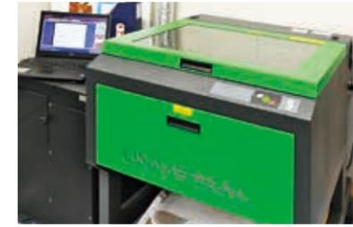
前ページで示した設計図のデジタルデータを用いてフレーム部分をカットする際に使用されたレーザーカッターマシン。
