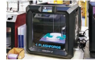
一般用より構造が複雑な耳鼻咽喉科用フェイスシールドのフレーム部分を製作する際に用いられた3Dプリンターマシン。
