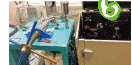
低振動数ラマン散乱の測定装置。右はサンプル室、左は超臨界用加圧装置と光学セル、奥は分光器本体。
