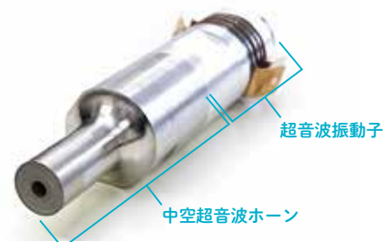
幕田先生が開発したマイクロバブル発生装置。気体を供給する管を超音波振動体にする事で気泡の多量生成が可能に。
