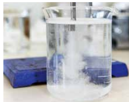
超音波利用型マイクロバブル発生装置の先端から微細な気泡が発生中。白く濁って見える部分がマイクロバブル。
