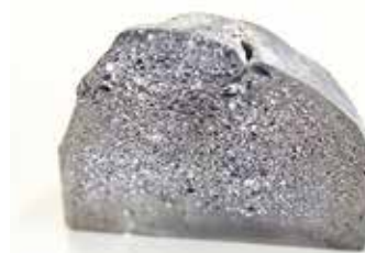
超音波利用型マイクロバブル発生装置で溶融金属中にマイクロバブルを発生させたもの。微細な気泡による工業材料の軽量化や断熱性などの向上も期待できる。
