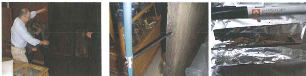
図 2. AMS 法で測定した長谷堂城大手門扉のサンプル採取。
