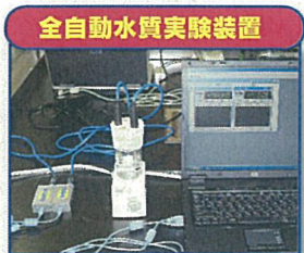
全自動水質実験装置 投入薬剤量とpH/ORP/温度の関係を、自動的に調べる。
