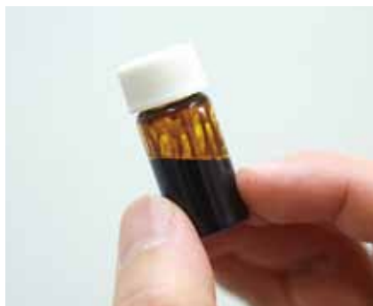
高効率・簡便、安価、さらに低環境負荷合成の「銀超微粒子高濃度独立分散インク」。エレクトロニクス分野はもちろん、多方面での実用化が期待されている。
