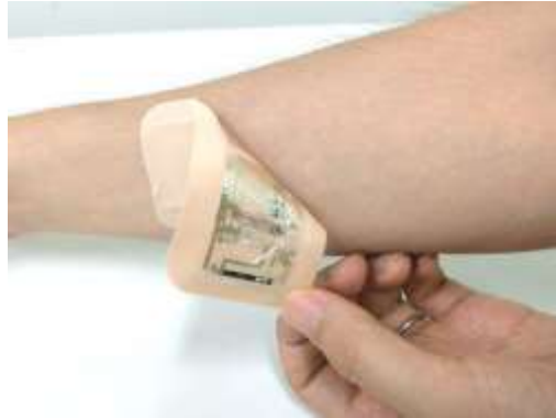
開発段階の絆創膏型の無線センサタグ(温度センサタイプ)
