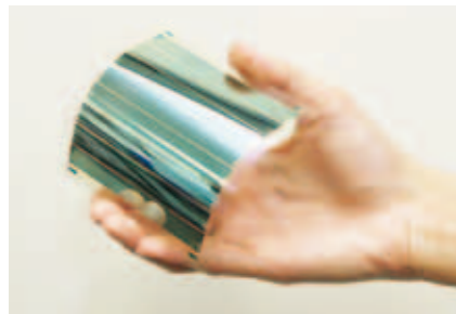
フィルム上に製造できるのでこんなに曲げられるのも有機薄膜太陽電池の特長。凸凹や湾曲面にも対応可能で広がる用途。
