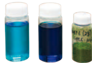
右の粉末状の有機物を溶媒に溶かしたものが左2本の液体。これが発電材料。分子構造によって光の透過性や発電効率に変化する。
