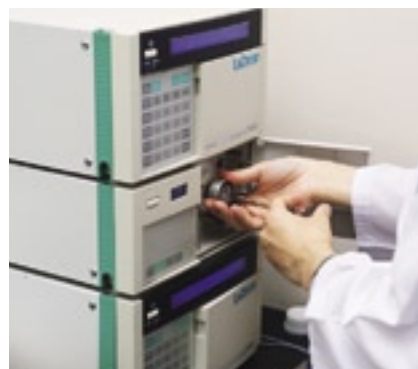
成分を分析するための装置。調べたい物を液状にして流し入れ、光を当て時間を追って成分の変化をチェック。
