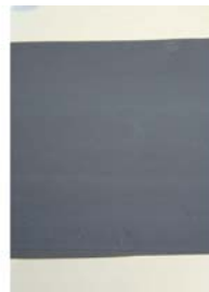
図4 急速充放電用正極の試作結果
