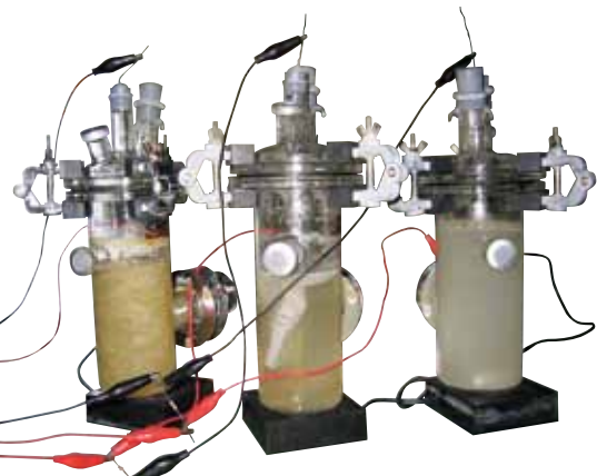
廃水を燃料とした微生物燃料電池。廃水中の汚れを電流発生微生物が分解してきれいにする時に生じる電子を、電極に捨てさせて電気を作り出す装置。
