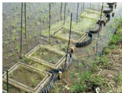
水稲は光合成で作った有機物の一部を土壤中に分泌する。水田発電では、土壌中の嫌気性微生物が、この有機物を分解し放出する電子を利用して発電する。
