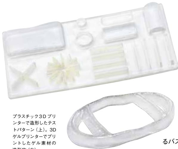
プラスチック3Dプリンターで造形したテストパターン(上)。3Dゲルプリンターでプリントしたゲル素材の造形物(右)。
