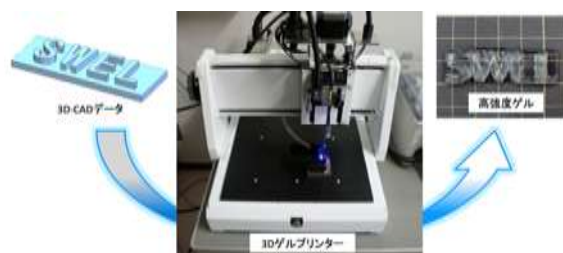
図2：3Dゲルプリンターの試作機。3D-CADで描画した3Dデジタルデータから、描画したデータどおりの高強度ゲルを3D自由造形できる
