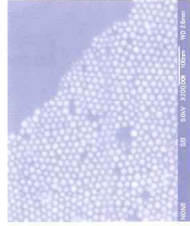
色素増感太陽電池は、酸化チタンと色素の微粒子を使い、太陽エネルギーを電気エネルギーに変換します。シリコン太陽電池より発電効率は低いです。形状や色を自由にできるメリットがあります。プラスチック型の軽やかな太陽電池を作成し、性能を評価します。
