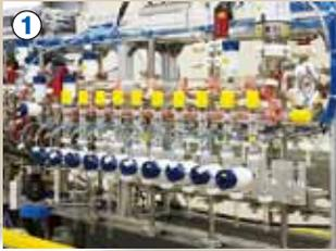
① グラファイト生成装置に極微量試料を装填し、燃焼させて炭素の粉、グラファイトを生成する。
