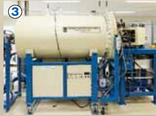
③ 電氣的に加速させ、アルゴンガスの中を通過させることで余計な水素などを剥ぎ取り、純粋な炭素にする。
