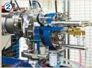
② グラファイト試料をAMSに装填し、セシウムイオンを衝突させて炭素をイオン化する。
