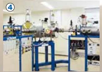
④ 電磁石によって炭素は曲がる。その曲がり具合は重さで変わるため、いちばん重い炭素14が別軌道に入り、存在比を測定することができる。
