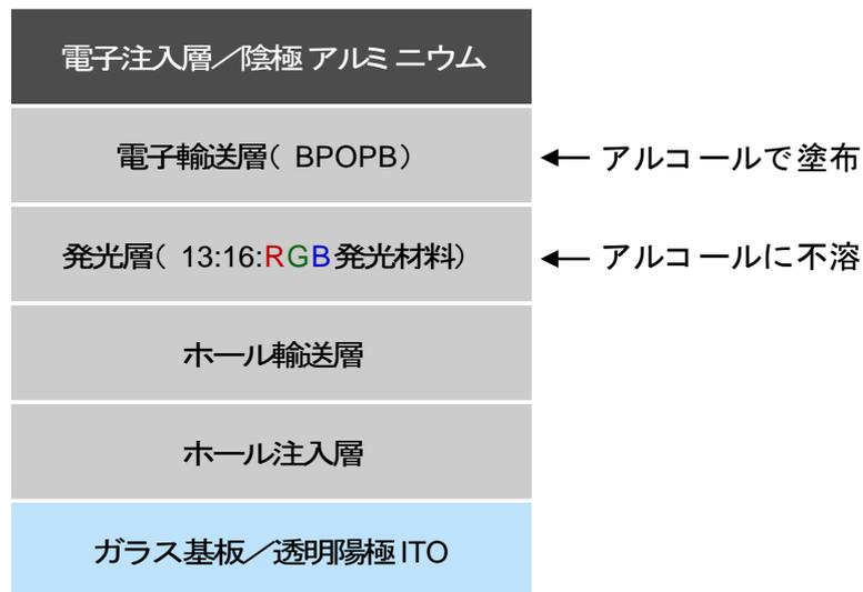
図3 発光層と電子輸送層の積層構造を用いて作製した、塗布型白色有機EL素子
