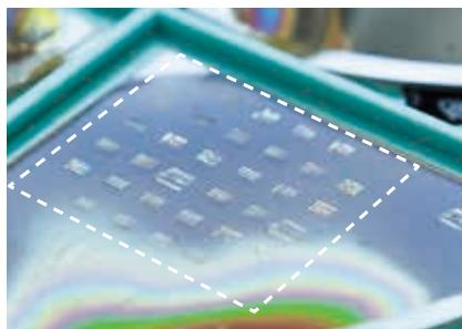
直径数十～数百 nm、高さ1 μm程度の柱状ナノ結晶のこと。画像では同じ見えるが、太さが変わると色や特性が変わる。構造の違いによって、現れる発光特性の変化を調べるために作製したさまざまなナノコラムアレイ構造。
