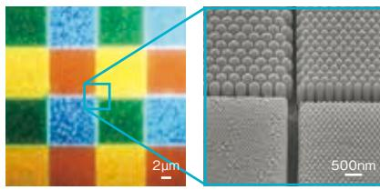
直径や周期の異なるナノコラムアレイ構造の電子顕微鏡像と発光像。コラム直径や周期を変化させると、発光色や発光強度が変化することに着目し、高効率な赤色発光が得られる構造を探求している。
