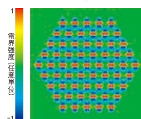
上図は、シミュレーションに用いたプラズモニック結晶を上から見た模式図。金色領域は金、青色領域は発光層、緑の六角柱はGaNナノコラムを表す。下図は、金／誘電体界面に発生する表面プラズモン起因の電界強度分布。
