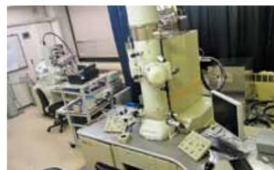
ナノ材料の観察に欠かせない電子顕微鏡設備
