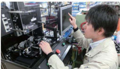
スマートウォッチ液晶パネル取付装置の開発風景
