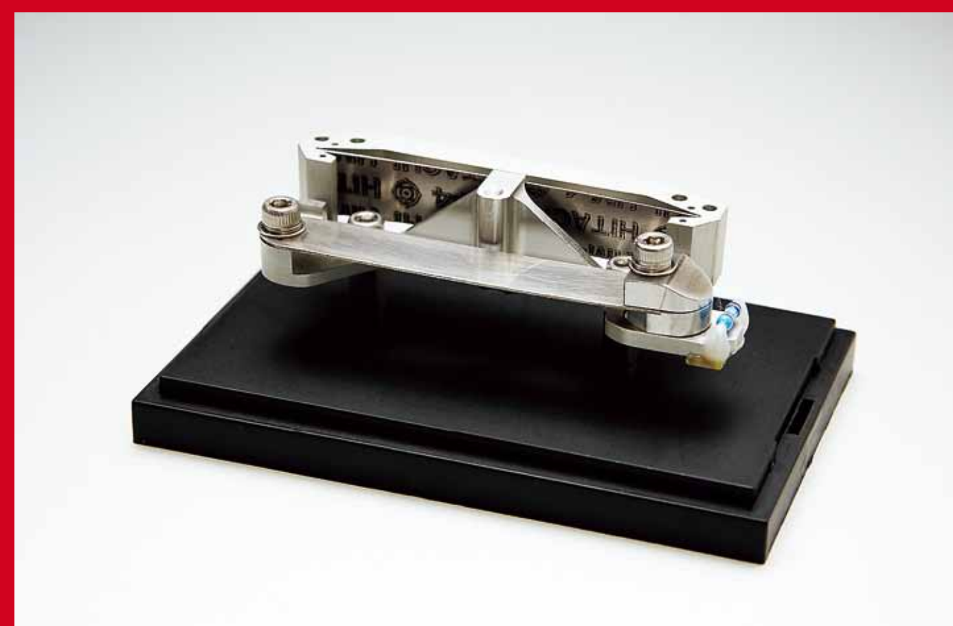
はやぶさ2に搭載された小惑星探査ロボット用環境駆動型移動機構
