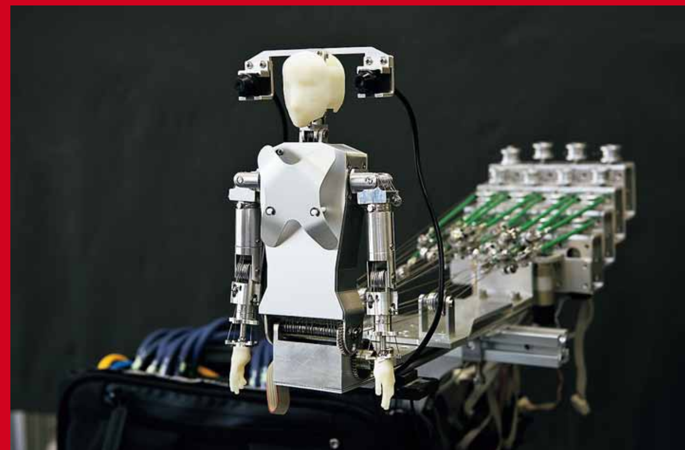
ウェアラブルミニチュアヒューマノイドによるテレイグジスタンスシステム
