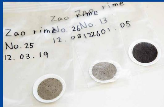
蔵王のアイスモンスター（樹氷）を溶かしたものを濾過したフィルター。黒い物が越境飛来した大気汚染物質。教授が手にしている容器に溶けた樹氷が入っている。
