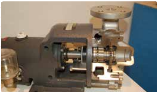
ニクニ渦流ポンプ。ローテクながら精密機械そのものです。
