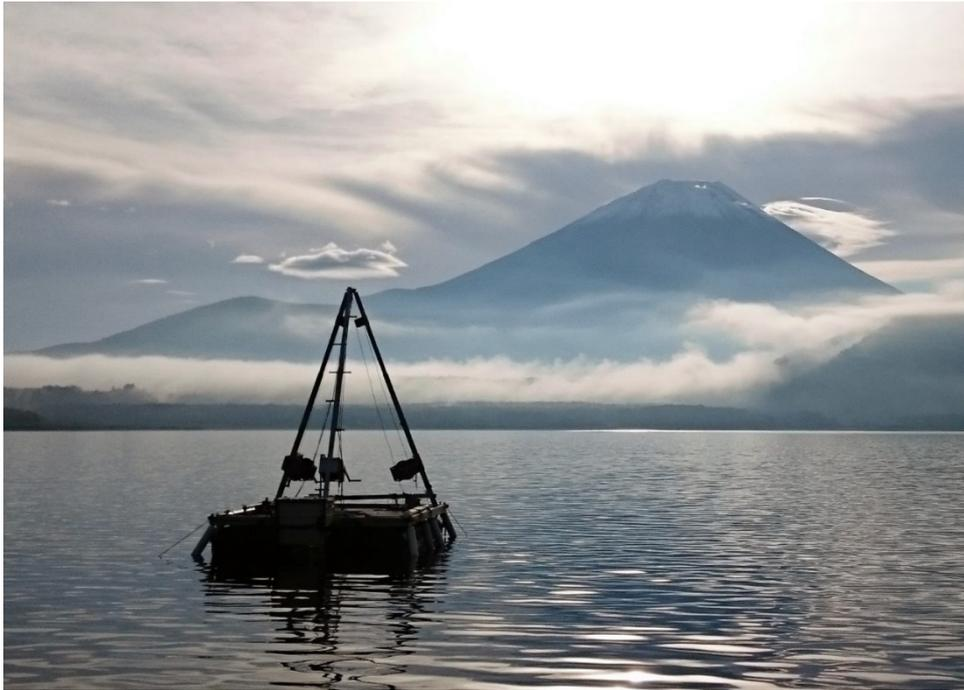
図1 本栖湖に浮かぶ掘削プラットフォーム。三角櫓からサンプラーを湖底に下ろす。
