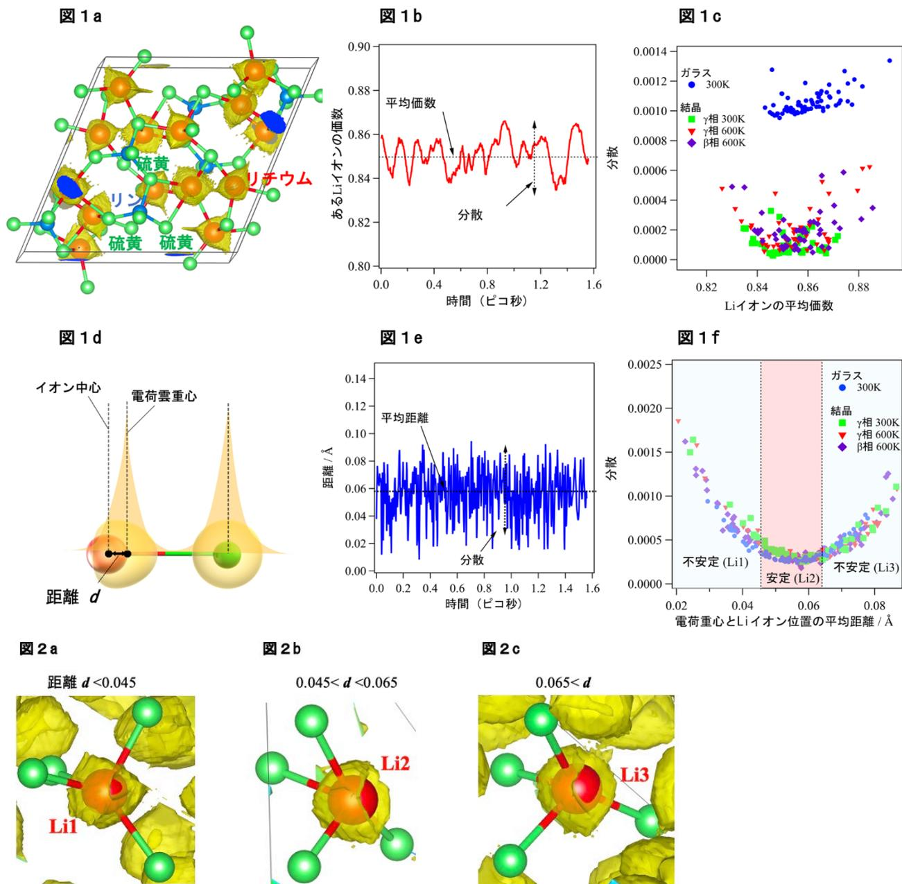
図1 : Bader 電荷分析法で評価した Li イオンの環境。(a)  $\text{Li}_2\text{S}-\text{P}_2\text{S}_5$  結晶の Bader 法から得られた Li イオンの電荷密度。(b) Li イオンの 1.6ps の間の平均価数振動と分散。(c) ガラス相<sup>※10</sup>、結晶  $\beta$  相、結晶  $\gamma$  相の Li イオンの平均価数と分散の相関。(d) Bader 解析で得られる距離情報。(e) 1.6ps 間の Li イオン位置と電荷雲重心の平均距離と分散。(f) ガラス相、結晶相各々の Li イオン位置と電荷雲重心の平均距離と分散の相関関係。
