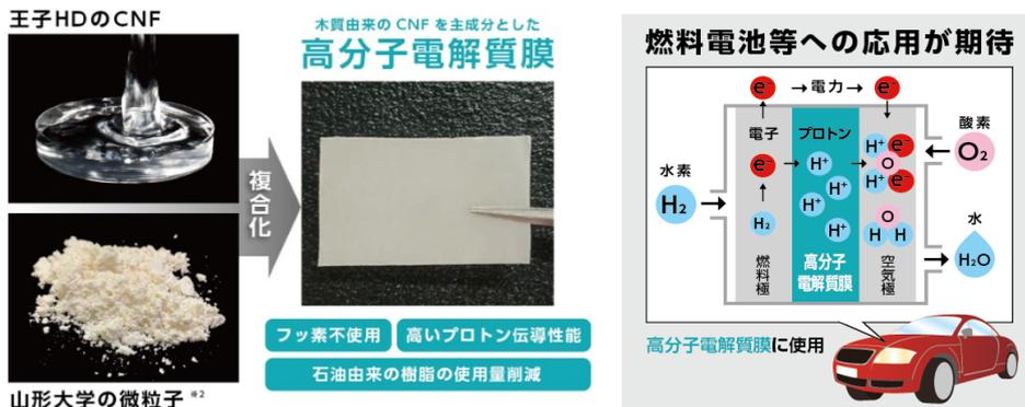
図 1. プロトン伝導性微粒子と王子HD独自のCNFを複合化した高分子電解質膜とその応用
