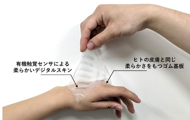
図1. 機能性有機材料を用いた触覚センサの構築
