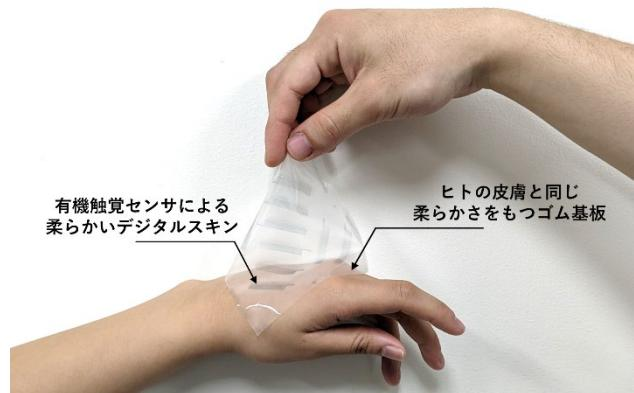
図1. 機能性有機材料を用いた触覚センサの構築
