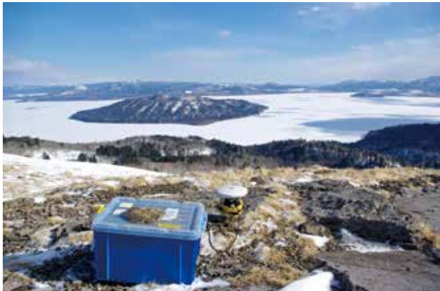
地震や火山活動に伴う地殻変動を、GPS等を使ってmmの精度で観測しています（屈斜路カルデラにて）
