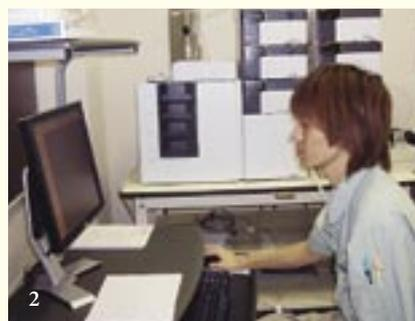
2 機器分析室にてサンプルを各分析装置で測定。奥に見えるのはLC/MS/MSという分析装置。定量法の開発においては、前処理条件もふまえて最適な定量法のメソッド(薬物をきちんと定量できるか)を確立していく。
