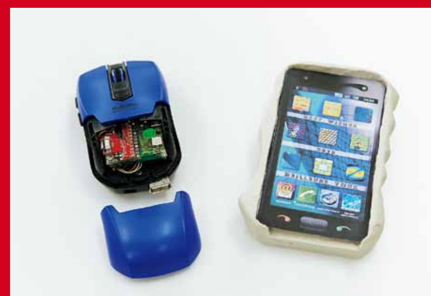
PCマウスやスマートフォン・ガジェットにセンサ基板を埋め込んだタンジブル脈波センサモジュール
