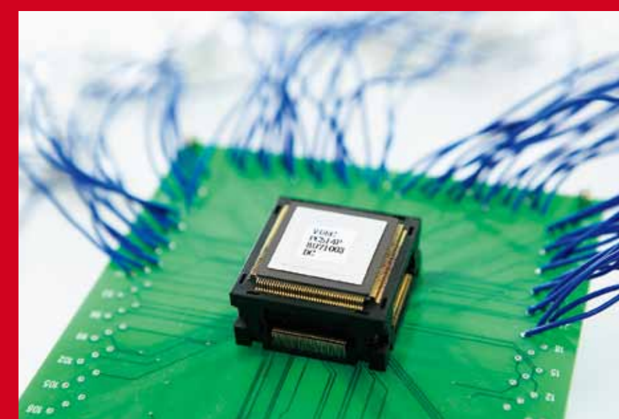
設計・試作した0.18 μm CMOS LS1チップ
