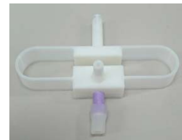
3Dプリンターで作製した吸引治具
