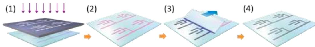
図 1 スーパーナップ法の模式図
