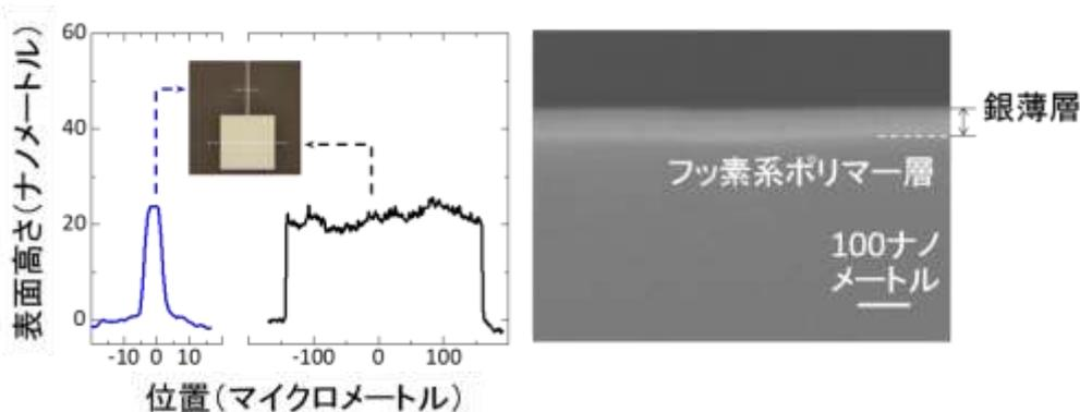
図 3 印刷した銀配線の厚み分布と断面電子顕微鏡写真
