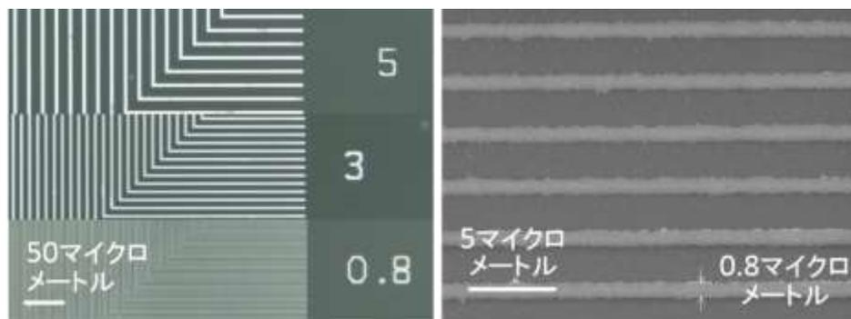
図 2 印刷した金属配線の顕微鏡写真
