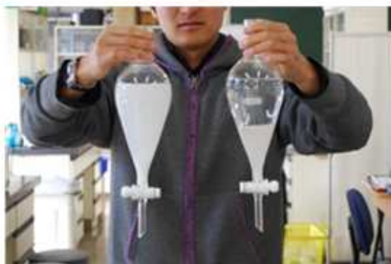
図2: 茹で麺排水処理試験(3時間後(右))
