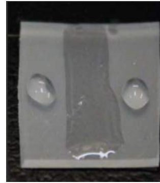
Fig1 改質部分だけが水に濡れるシリコン
