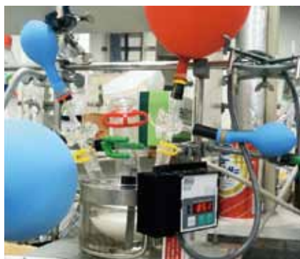
二酸化炭素を用いる反応の基本的な実験装置。効率よく反応させるために利用している風船が研究室をカラフルに彩る。
