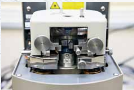
観察対象を目には見えない小さな針で触れながら走査(スキャン)して、物質の表面構造をナノメートルレベルで観察する装置(走査型プローブ顕微鏡[原子力顕微鏡])と、その画像と解析データ。
