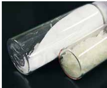
低エネルギーでの二酸化炭素利用を目指した二酸化炭素変換で得られたモノマー(単量体/写真左)と、そのモノマーの反応により得られたポリマー(ポリウレタン的一种/写真右)。
