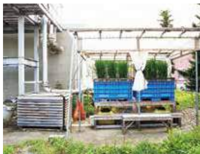
鶴岡キャンパス内に設置された実験用の水田模型。左手にある大型タンクから常時、下水処理水が供給されている。水の量や土壌を変えて生育状況の違いを観察。
