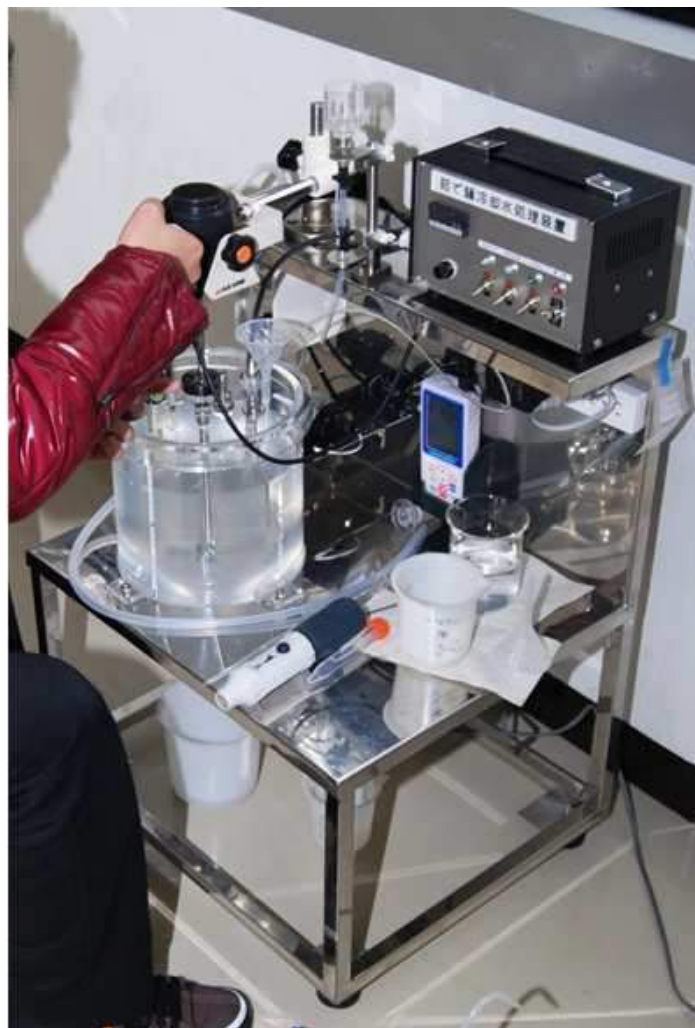
【特許番号】 特許第5829800号 【発明の名称】 茹で麺廃水の浄化装置
