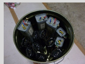
▲今回新たに発見された高濃度PCB使用安定器
