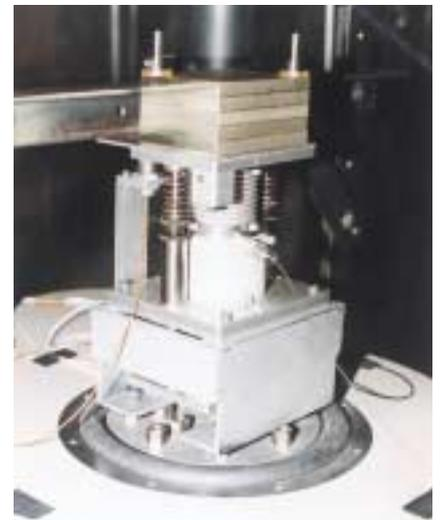
写真4 ER流体を用いた可変減衰ダンパと振動制御実験
