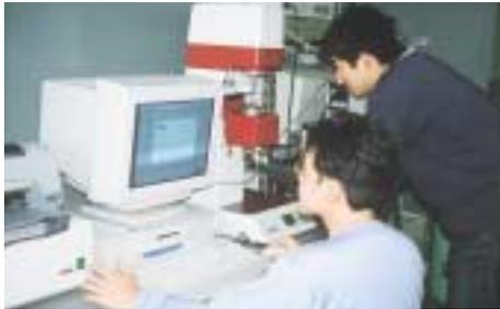
写真3 電磁場印加型レオメータによるレオロジー測定とマイクロ流動特性の観測
