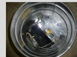
▲小型コンデンサならびに実験装置安定器（パール缶封入済み）
