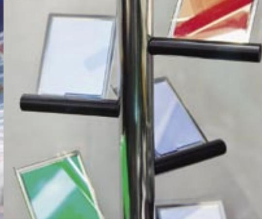
完成した色とりどりの有機ELパネル。分子設計を変えることで有機発光物を自由に組み合わせ、多彩な発光色を実現している。
