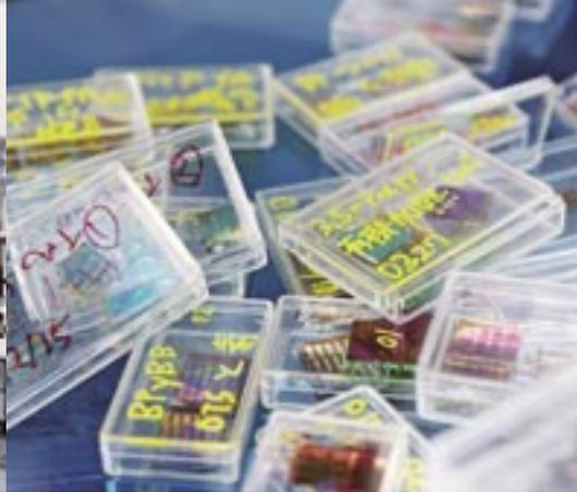
電子顕微鏡により分子配列を確認するために、さまざまな条件の下に作られた有機ELパネルのサンプルの数々。
