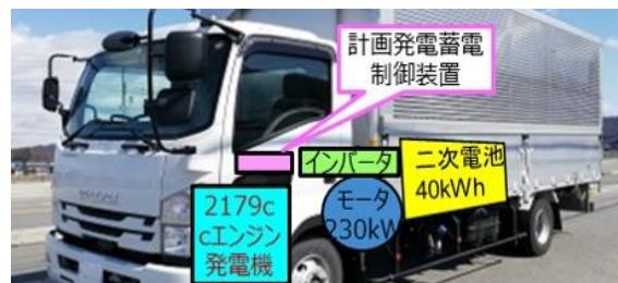
計画発電蓄電制御装置を搭載したトラックの構成要素
